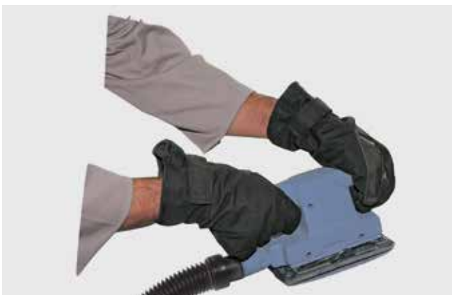
Bild 4-30: Anti-Vibrationshandschuh für den Einsatz bei hochfrequenten Schwingungen
