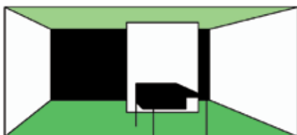
Bild 4-14: Unterschiede in der Leuchtdichte am Arbeitsplatz; oben: Kontrast weich, flau, unbefriedigend Mitte: Kontrast 1:3 bis 3:1, ausgewogen unten: Kontrast größer als 3:1, hart
