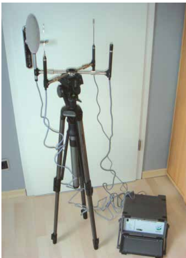
Bild 4-7: Messeinrichtung der Berufsgenossenschaft für Klimamessungen zur gleichzeitigen Erfassung mehrerer Messgrößen
